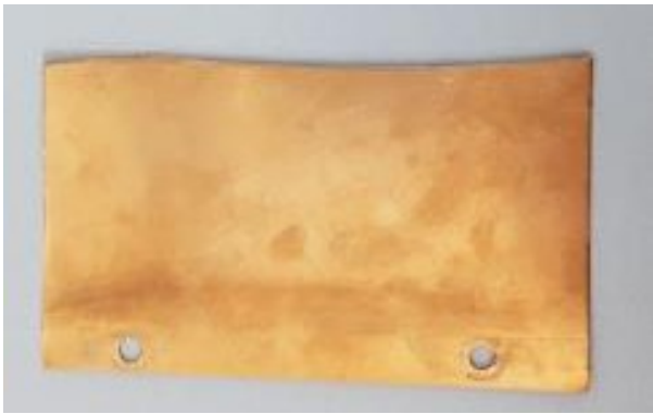
Abbildung 15: Abstreifblech des Korona-Walzenscheiders hamos KWS-XS
