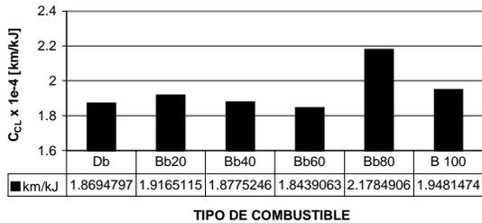
Figura 5. Recorrido del vehículo por unidad de energía liberada (C<sub>CL</sub>) diesel bajo azufre, biodiesel y sus mezclas
