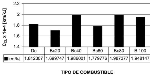
Figura 4. Recorrido del vehículo por unidad de energía liberada (C<sub>CL</sub>) diesel común, biodiesel y sus mezclas.
