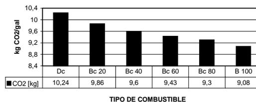
Figura 8. CO<sub>2</sub> para diesel común, biodiesel y sus mezclas.
