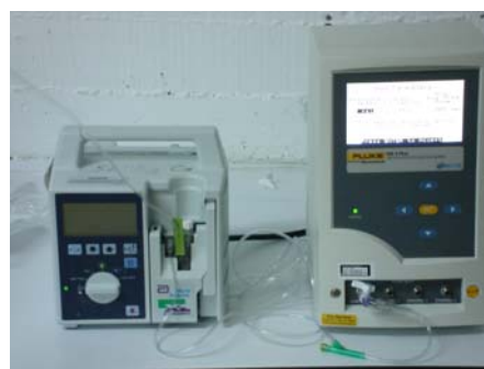
Figura 2. Conexión del analizador IDA-4 PLUS y la bomba de infusión
