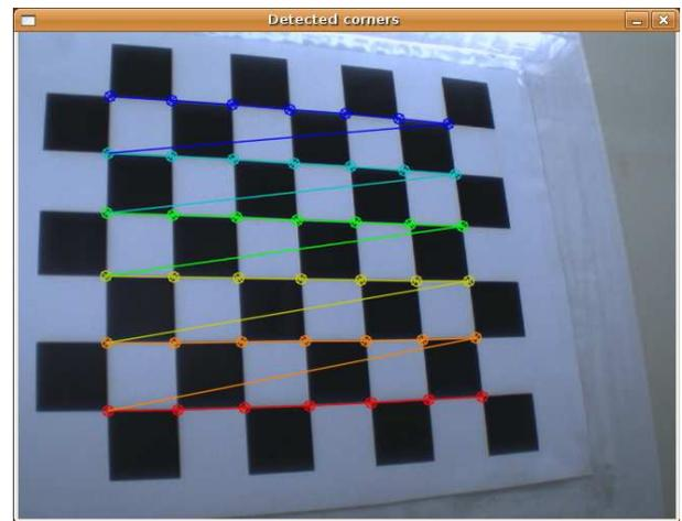
Figura 3. Detección de esquinas del patrón de calibración
