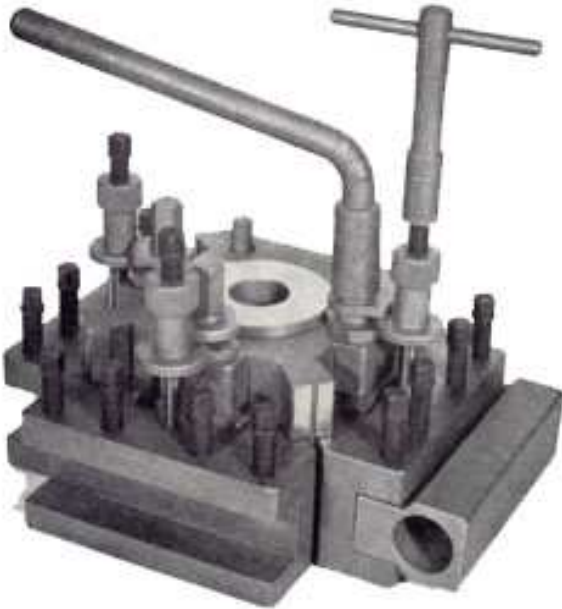
Figura 2. Vista general Torreta porta-herramienta de tres soportes con guía [2]
