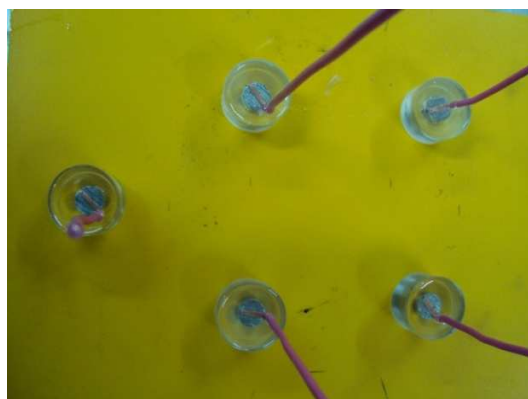
Figura 1. Montaje de los electrodos de SS 316 y dúplex 2205 de 1\text{cm}^2 de superficie expuesta.
