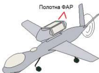
Рис. 5. Размещение ФАР над фюзеляжем БПЛА-носителя
