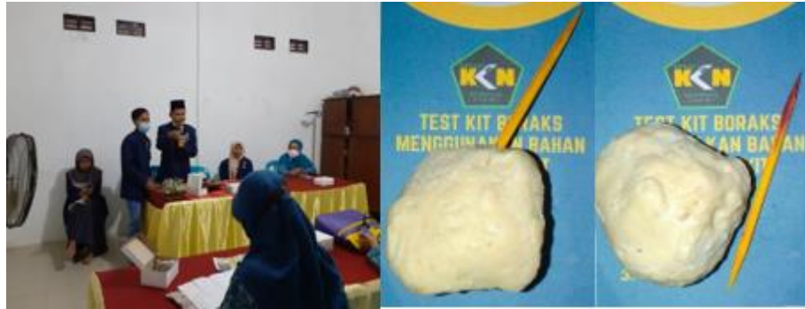
Gambar 2. Uji coba test kit dalam mendeteksi kandungan boraks pada makanan
