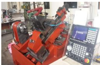
Gambar 1. Mesin bubut CNC Inovasi
