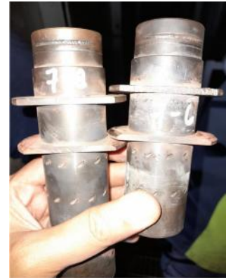
Gambar 15. Kerusakan Pada Cross Fire
