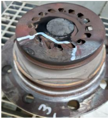
Gambar 14. Kerusakan Pada Fuel Nozzle
