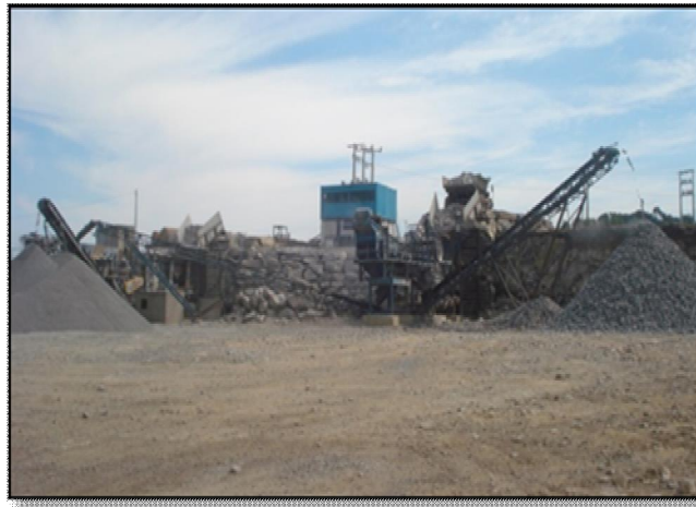
Figura 6 - Beneficiamento de minerais com cominuição (Britador).
