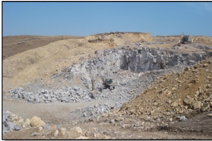
Figura 4 - Extração de minerais em rocha eruptiva básica (Pedreira).
