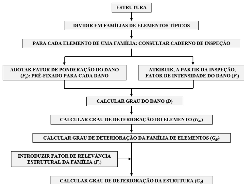
Figura 1. Fluxograma para avaliação do grau de deterioração de estruturas de concreto da Metodologia GDE/UnB (Boldo, 2002 – editado).
