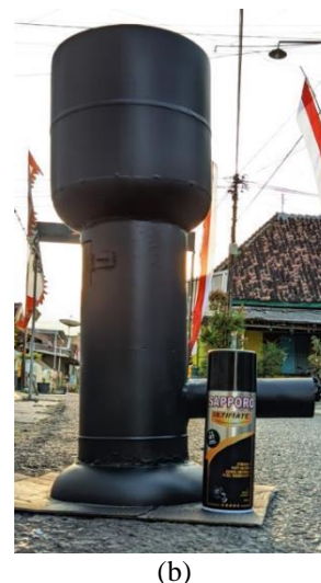
Gambar 1 (a) Skema burner berbahan bakar biomassa, (b) Hasil fabrikasi
