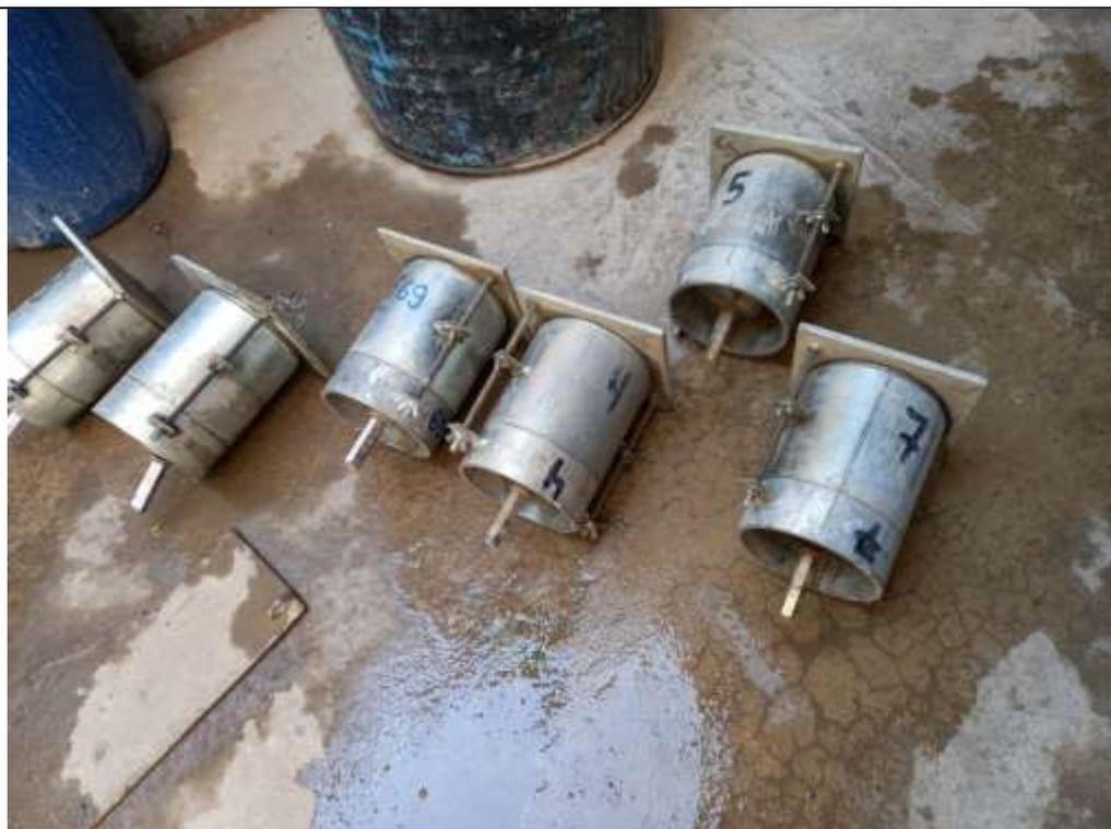
Escurrecimiento de agua de las muestras para la prueba de penetración
