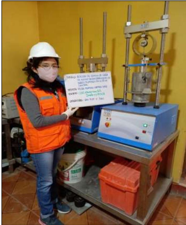
*Figura 17.* CBR de suelos – prueba de carga
