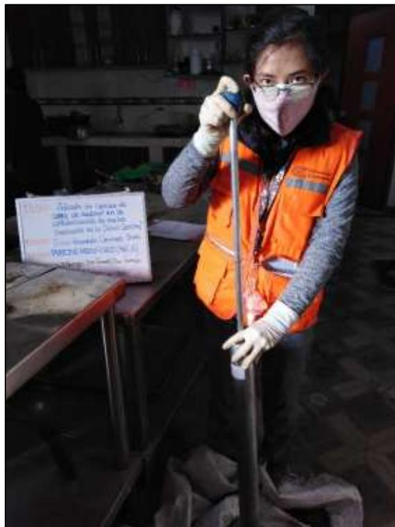
*Figura 15.* Ensayo de proctor modificado
