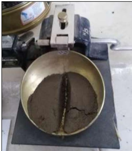
*Figura 13.* Ensayo de límite líquido
