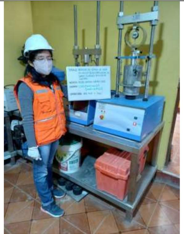
Prueba de penetración – suelo con 10% de ceniza de caña de azúcar
