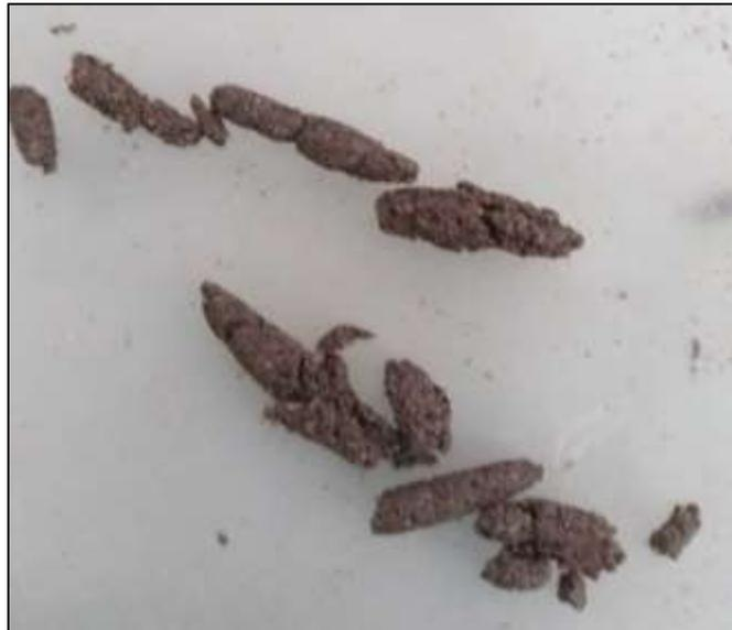
*Figura 14.* Ensayo de límite plástico
