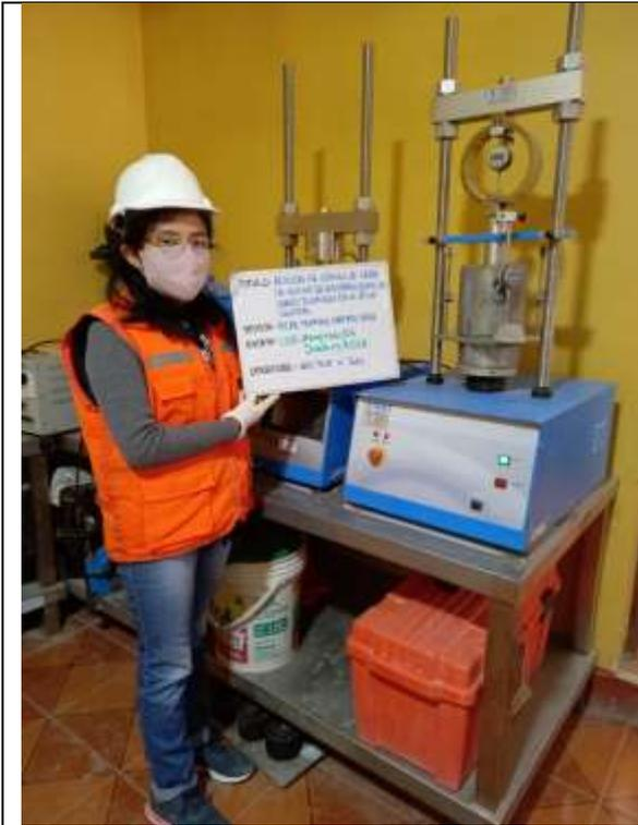
Prueba de penetración – suelo con 5% de ceniza de caña de azúcar
