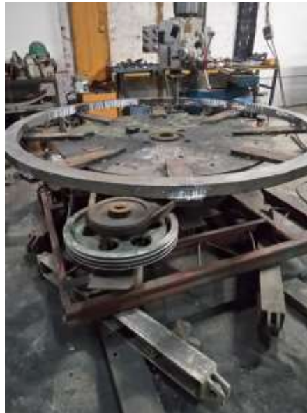
Figura 96. Vista general del torno horizontal con el montaje de un anillo
