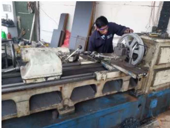
Figura 88. Construcción de poleas
