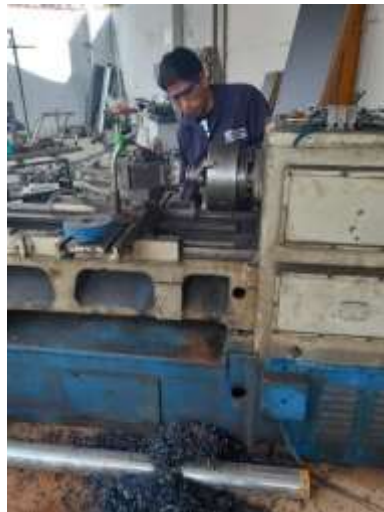
Figura 86. Construcción de eje
