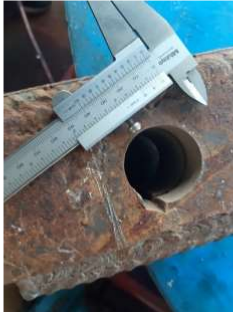
Figura 90. Medición de profundidad de arranque
