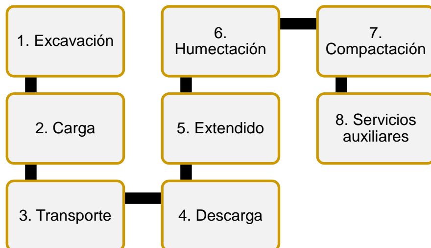
Figura 2. Diagrama de actividades de las operaciones de movimiento de tierras. Fuente: Tomada de “Análisis y ejecución de movimiento de tierras en una obra empleando el diagrama de curva masa”, por Guevara Martínez. 2015.
