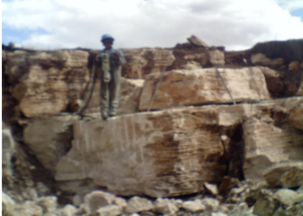
Figura 40. Perforación para la extracción de bloques en la cantera Leonardito 2007 Tomado de SMRL Mateo Sandro
