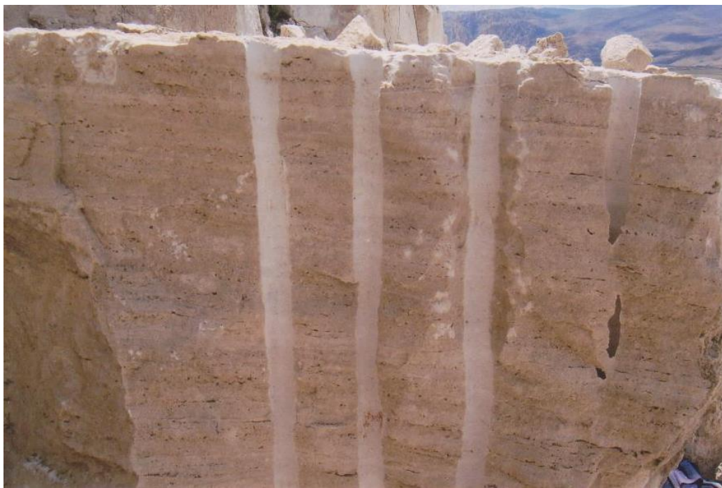
Figura 56. Bloque para terminar de recuadrar en la cantera Mateo Sandro Tomado de SMRL Mateo Sandro
