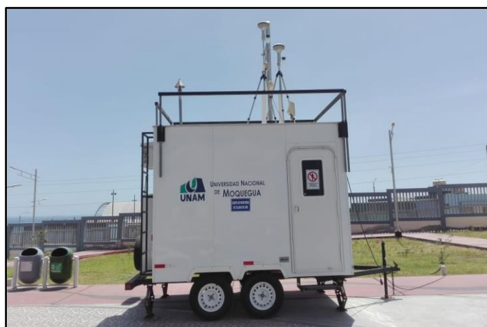
Figura 15. Caseta fija de la estación de monitoreo UNAM-MOQ, Ilo, Perú.
