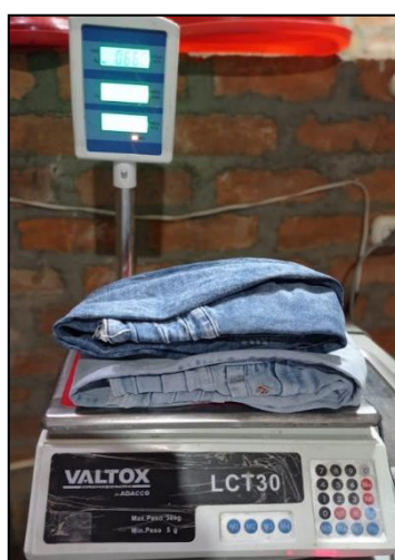
Figura 1. Prendas que van a pasar por el proceso de teñido, el peso no debe exceder los 700 g.
