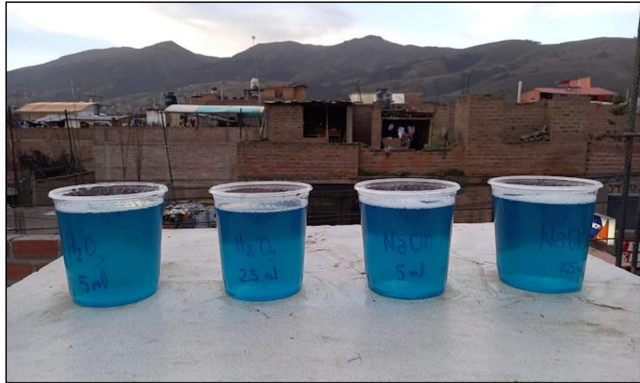
Figura 11. Muestras de 0.8 L de H 2 O 2 y NaClO de 5 y 2.5 mL.
