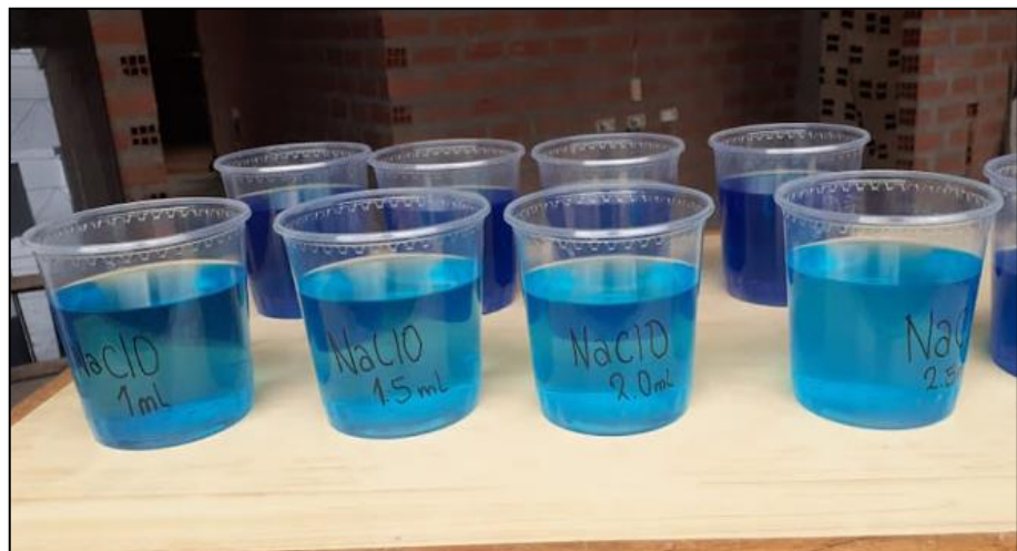
Figura 14. Muestras de agua residual donde se aplicó 1.0 mL, 1.5 mL, 2.0 mL y 2.5 mL de NaClO al 5 %.
