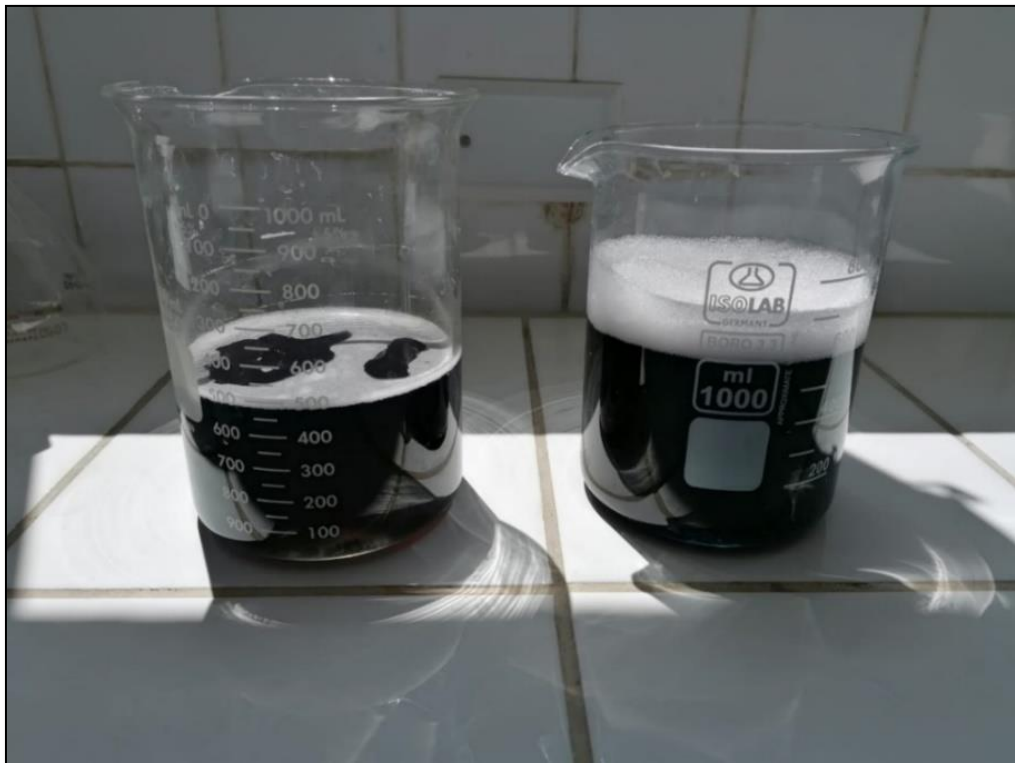
Figura 25. Muestras del peróxido de 2,5 y 15 ml bajo radiación. Nota: se observa formación de sedimentos, burbujas y espuma.
