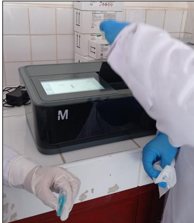
Figura 21. Colocar agua destilada en una cubeta de cuarzo para la muestra en blanco con un valor de 670 de absorbancia.
