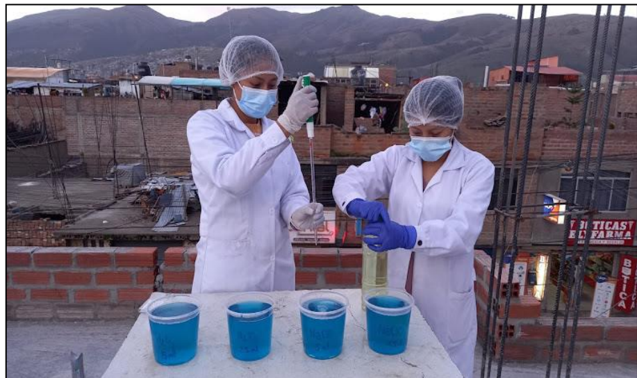
Figura 12. Se agregan los oxidantes para el tratamiento del agua residual.
