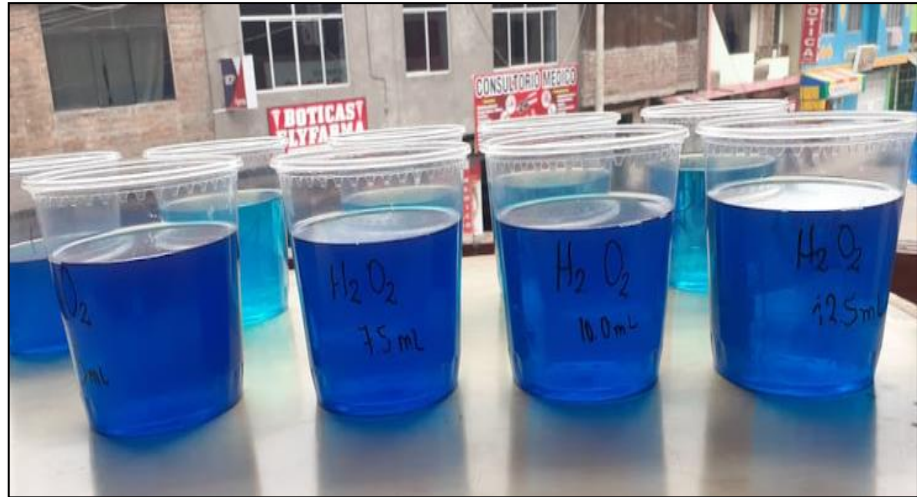
Figura 13. Muestras de agua residual donde se aplica 5,0 mL, 7.5 mL, 10 mL y 12.5 mL de H_2O_2 al 30 %.
