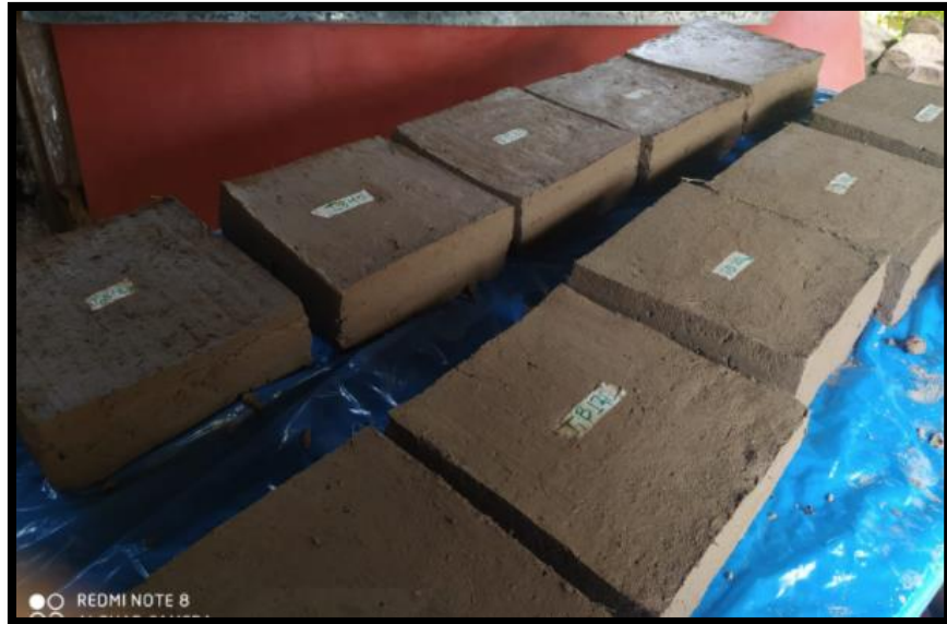
Fotografía 24. Adobes retirados del molde de patrón "B" con dimensión 24 x24 x9 cm
