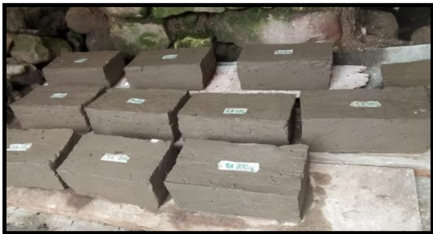
Fotografía 25. Adobes retirados del molde de patrón "A" con dimensión 24 x12 x9cm
