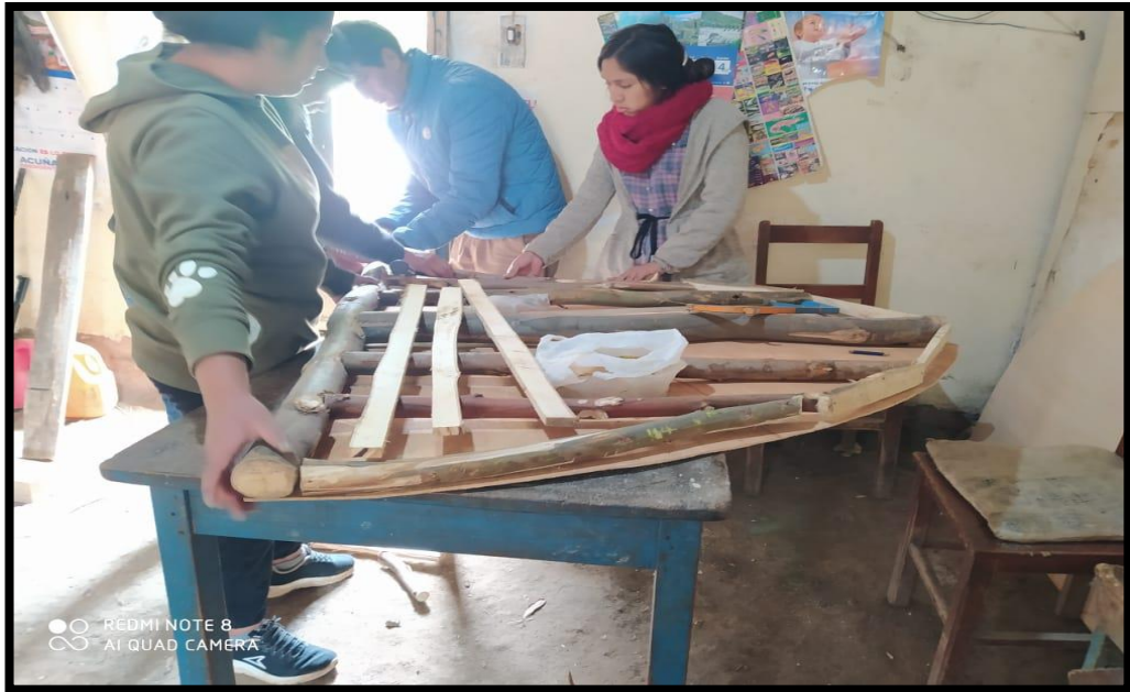
Fotografía 39. Unión de las maderas con clavos, para una mejor resistencia.
