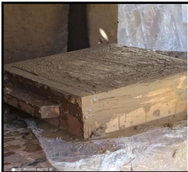
Fotografía 23. Comprimido de la mezcla en los moldes
