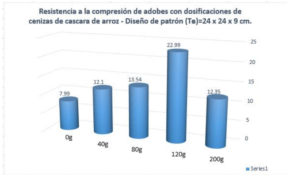
Figura 44. Resistencia a compresión de los adobes de Patrón (T B ):24 x 24 x9cm. Fuente: Elaboración de tesis
