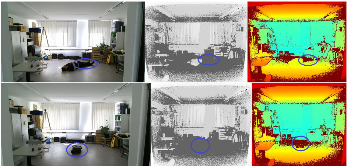
Abbildung A.2: Anfälligkeit des Kameramoduls für starke Beleuchtung
