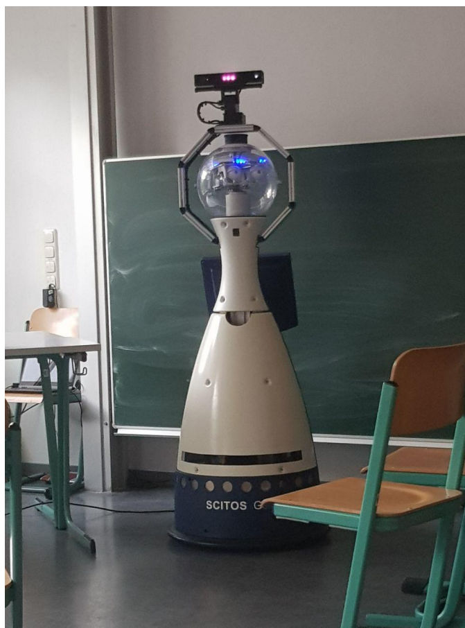
Abbildung 1.2: Roboter „Anna Constantia“ – eine mobile Plattform vom Typ Scitos G5, hergestellt von MetraLabs
