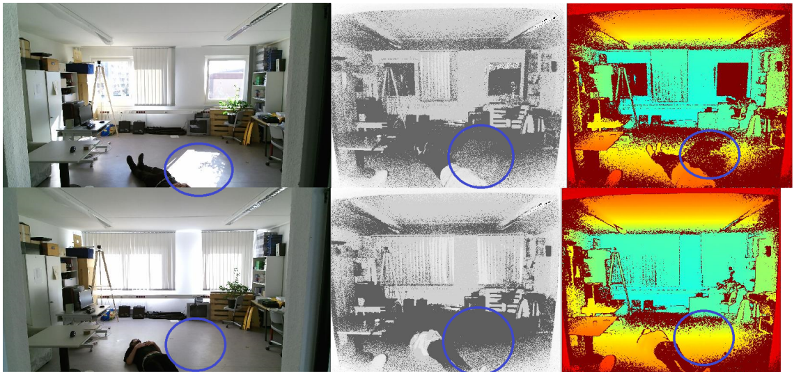
Abbildung A.1: Anfälligkeit des Kameramoduls für bestimmte Oberflächeneigenschaften
