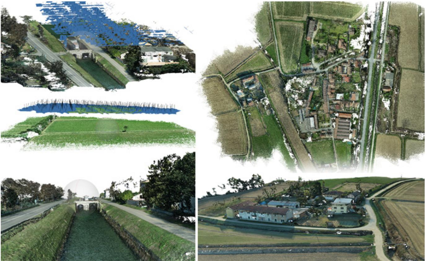
Fig. 6 Viste di nuvole di punti ottenute tramite acquisizione fotogrammetrica close range condotta con drone DJI Phantom 4 RTK. I singoli chunk sono stati allineati mediante software metashape e poi importati direttamente in Cyclone.
