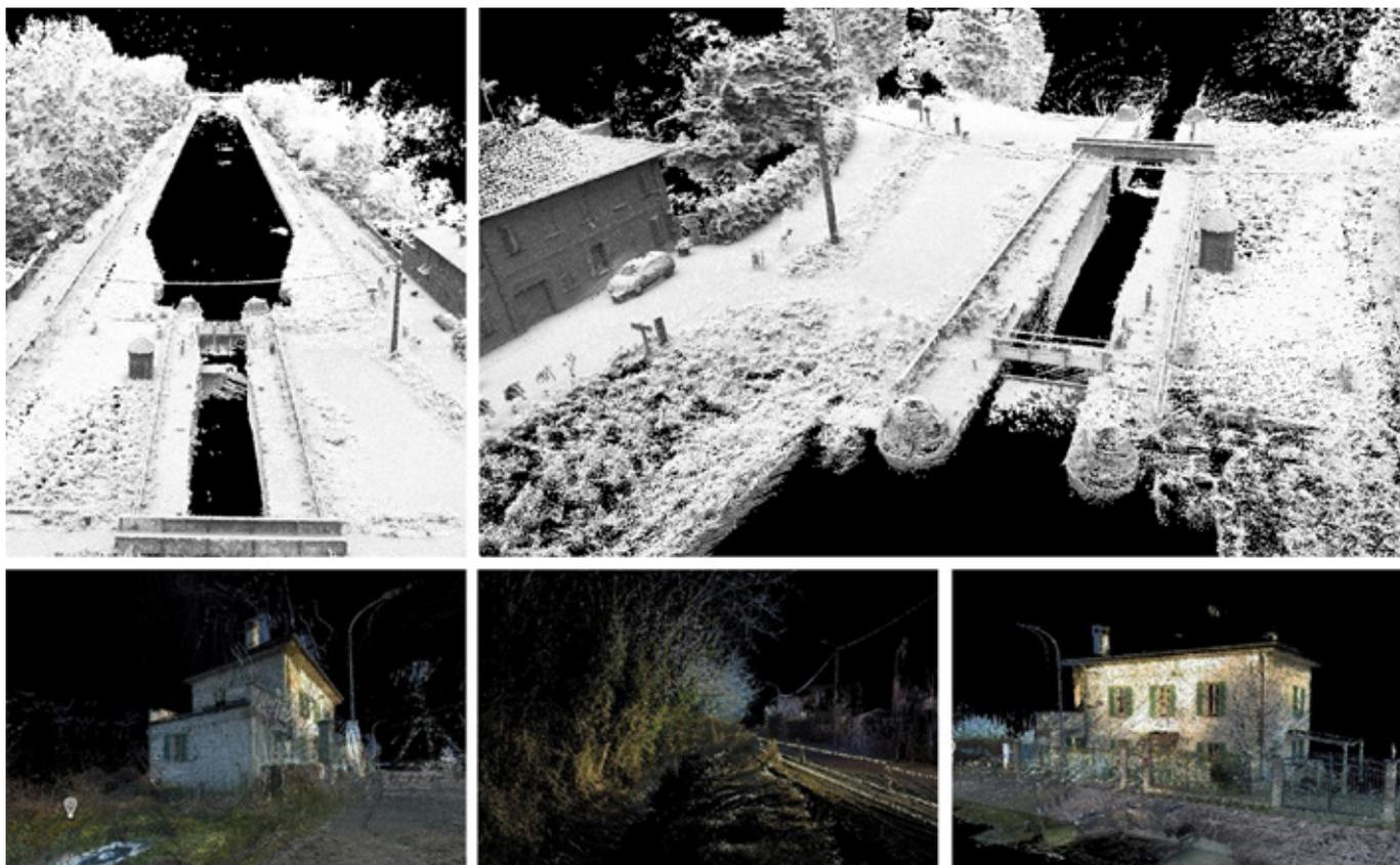
Fig. 5 In alto nuvole di punti del Naviglio Pavese ottenute con mobile laser scanner ZEB HORIZON. Le scansioni sono state elaborate sul software proprietario GeoSLAM Hub e poi sono state gestite mediante il software cloud compare. In basso nuvole di punti di alcune porzioni di architettonico in prossimità del Naviglio acquisite mediante laser scanner mobile BLK2GO, registrate direttamente in ambiente Cyclone.
