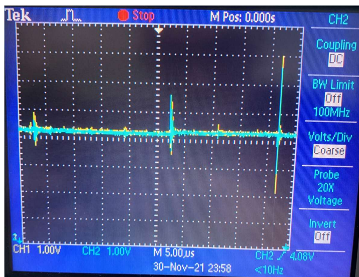
Figur 19: Spenningskurver, DC-side, blå er small loop, gul er big loop
