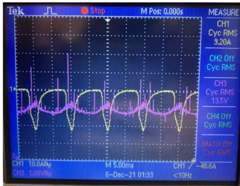
Figur 36: Landstrøm med ferritt, DC side. Rosa=DC, gul=ampere
