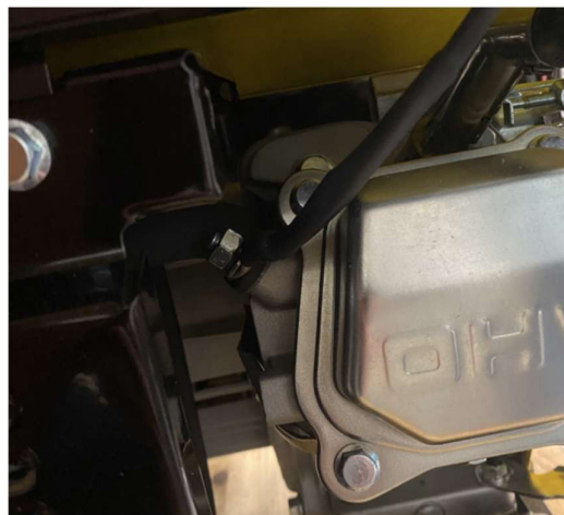
Figur 12: Feste til temp. sensor på aggregat
