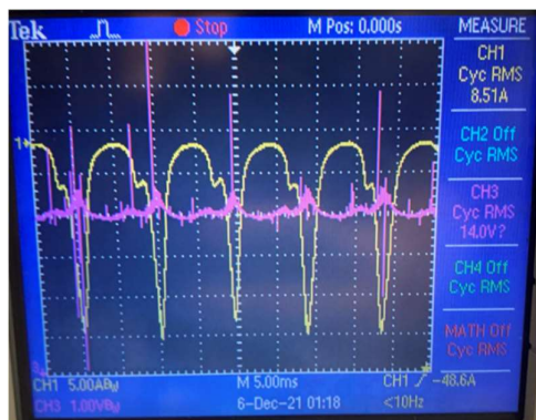
Figur 25: Generatordrift med ferritt, DC side. Gul=ampere, rosa= DC
