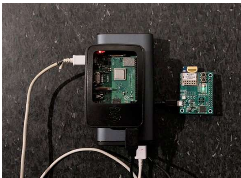
Figur 3.5: Tagen tilkoblet Raspberry Pi og batteribank for strømforsyning.
