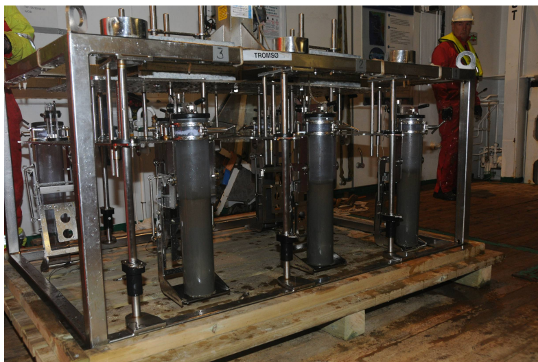
Multicorer, med kjerneprøver av sediment. Foto: Beate Hoddevik/Havforskningsinstituttet
