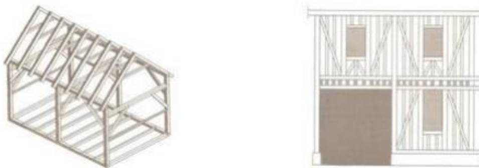
Figura 75: a) Sistema Porticado; b) Sistema Entramado (Torres 2010).
