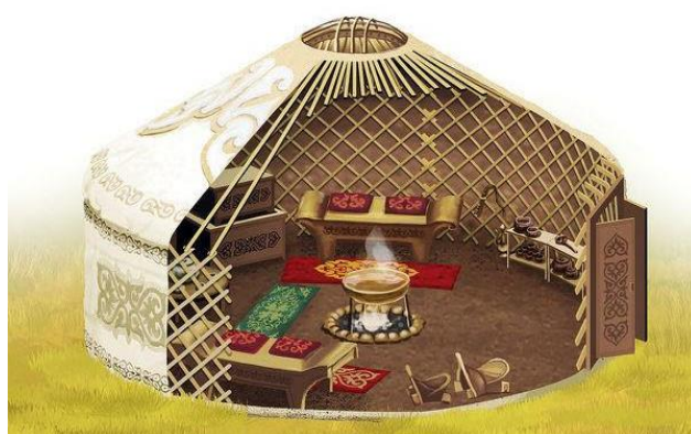
Figura 30: Secção de um Kiiz ui , onde mostra a sua estrutura interior em madeira ( Print of Kazakh yurt in cross section, Kazakhstan [sem data]).
