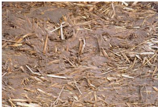
Figura 59: Aspeto final após junção da terra com palha ( Formed Earth (straw clay) ) [sem data].
