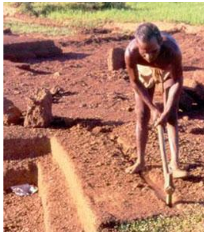
Figura 45: Processo de corte de blocos de terra em Orissa, Índia ( Cut Blocks [sem data]).
