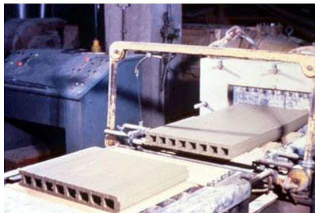
Figura 57: Processo de criação de tijolos de terra extrudidos ( Extruded Earth [sem data]).
