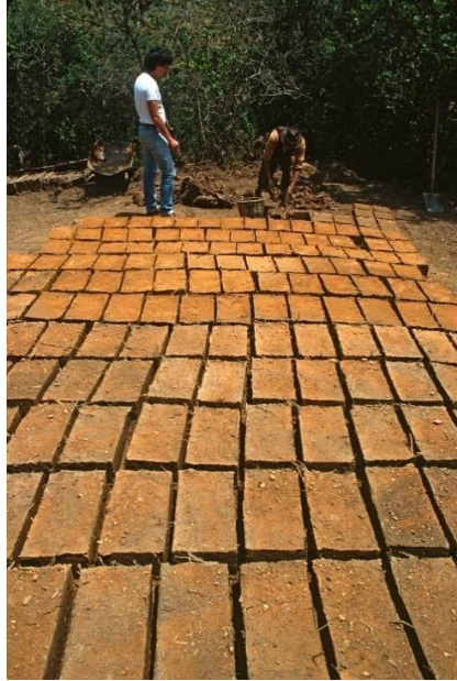
Figura 56: Processo de secagem dos blocos de Adobe (Pulido [sem data]).
