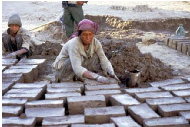
Figura 55: Moldagem de blocos de Adobe em Ladakh, Índia ( Adobe Moulding [sem data]).
