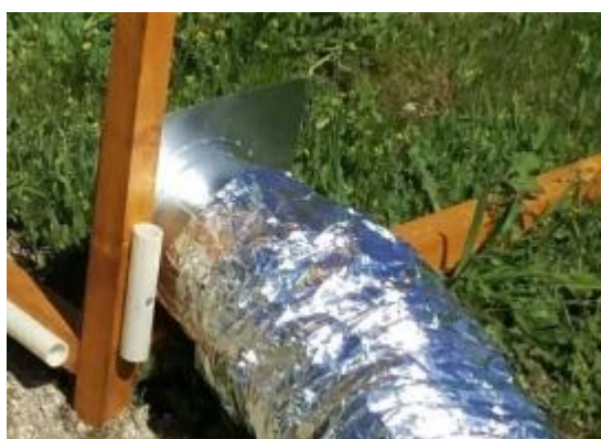
Figura 3.5 - Aplique de metal utilizado nas aberturas da estufa com conduta de ventilador acoplada.
