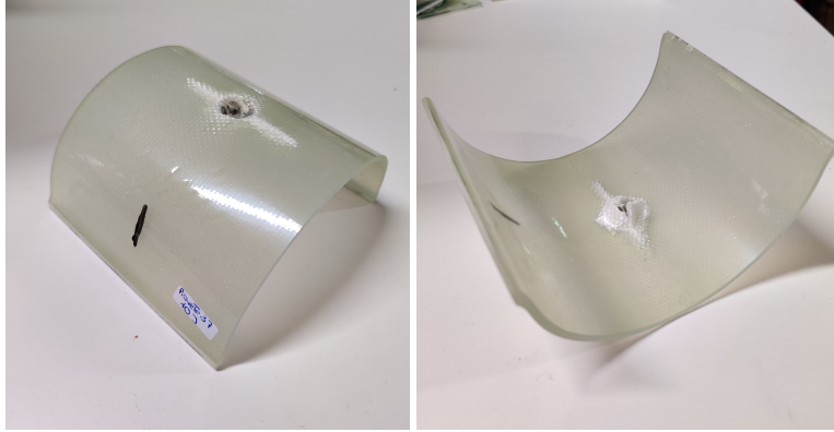
Figura 3.14: Dano final nos provetes de controlo, para 10J.
