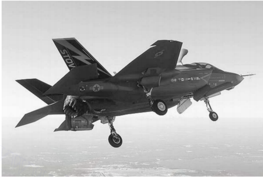
Figura 1.1: Lockheed Martin F-35 Lightning II Joint Strike Fighter com a fuselagem e as asas com estruturas em materiais compósitos [12].
