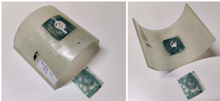
Figura 3.16: Dano final no provete com reparação dupla de 35 mm para 10J.
