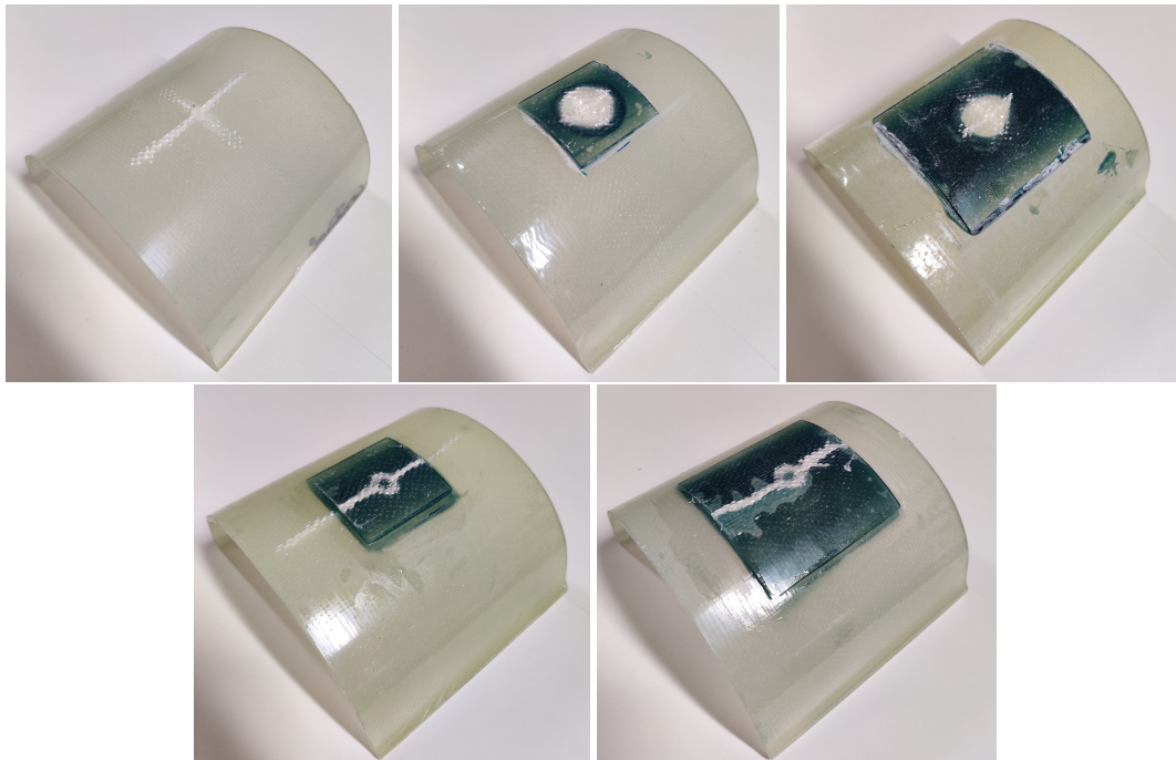
Figura 3.3: Dano final nos ensaios estáticos de todas as geometrias (em cima- controlo e simples de 35 e 55 mm; em baixo- duplo 35 e 55 mm).
