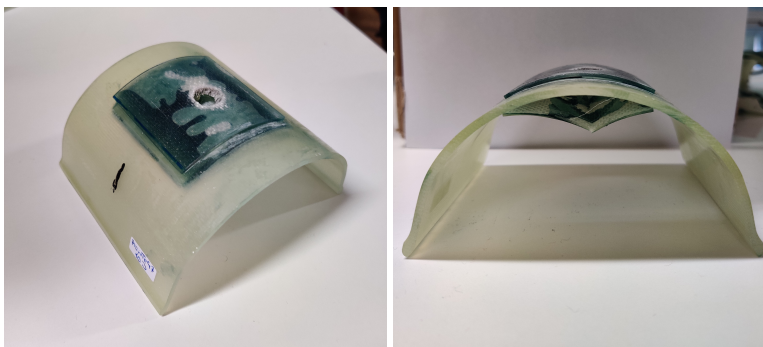
Figura 3.15: Dano final nos provetes duplos de 55 mm, para 10J.
