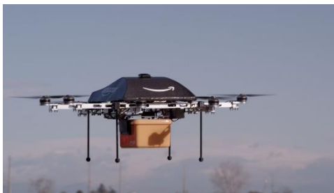
Figure 1 - Amazon prime air UAV. Fonte: [5].
