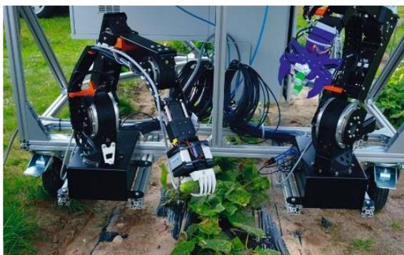
Figura 23 - CATCH- Sistema de colheita com dois braços robóticos articulados [37].
