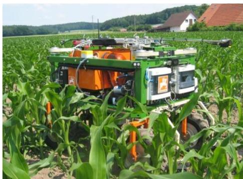
Figura 4 - Robô de pulverização de precisão Weedy [12].
