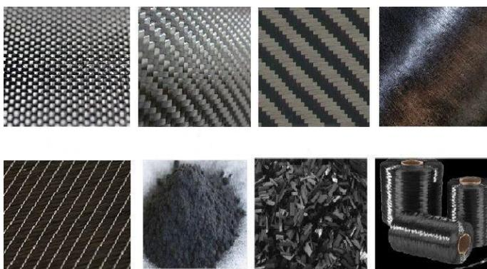
Figura 38 - Exemplos de tipologias de fibra de carbono [77].
