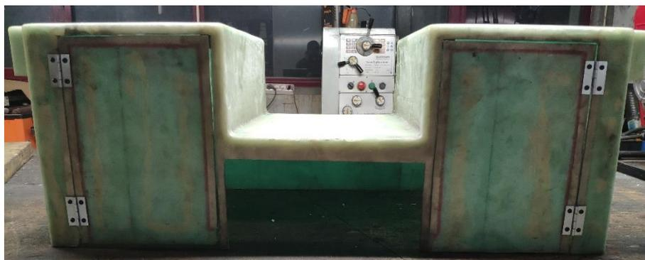
Figura 63 - Caixa de proteção antes do acabamento.
