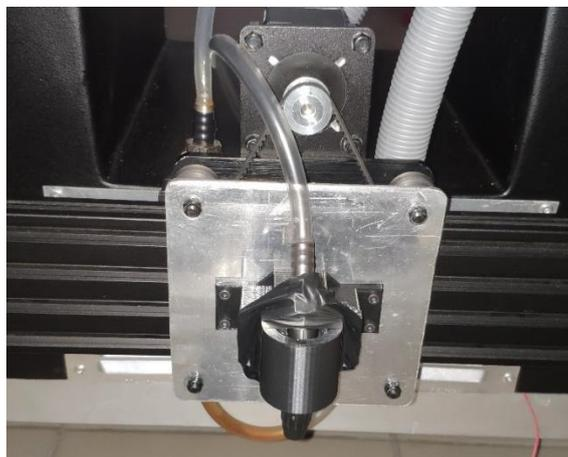
Figura 78 - Bico de pulverização.
