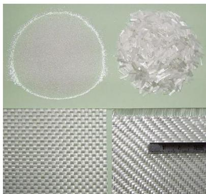
Figura 37 - Exemplos de tipologias de fibra de vidro [75].
