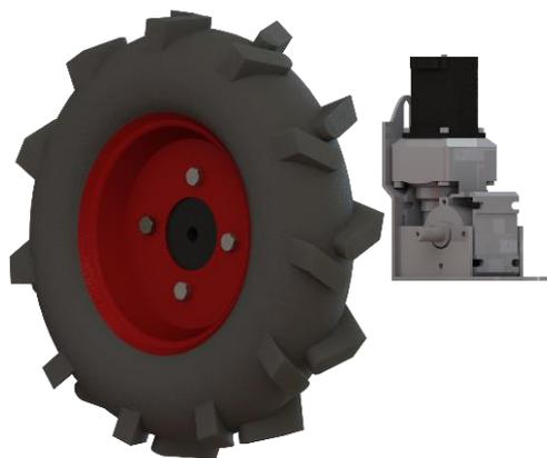
Figura 56 - Conjunto roda e motor.
