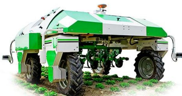
Figura 8 - Robô Dino da Naio Technologies [16].
