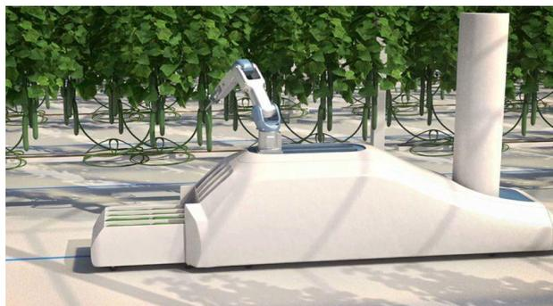
Figura 22 - Sistema robótico de colheita e armazenamento de pepino da Crux Robotics [36].
