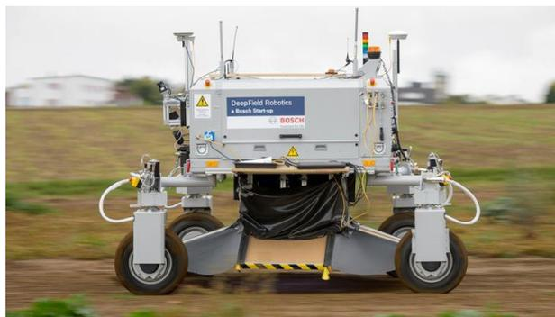
Figura 10 - BoniRob robô de remoção mecânica de infestantes
