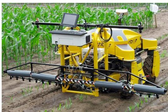
Figura 2 - Robô de pulverização de precisão Hortibot [9].
