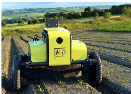
Figura 5 - Asterix robô de pulverização de precisão [13].
