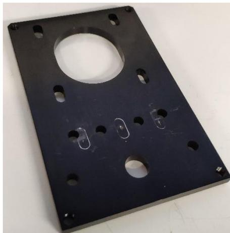
Figura 73 - Placa de acoplamento do motor na traseira a do eixo.
