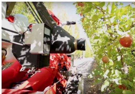
Figura 24 - Mecanismo de colheita da Abundat Robotics [39].
