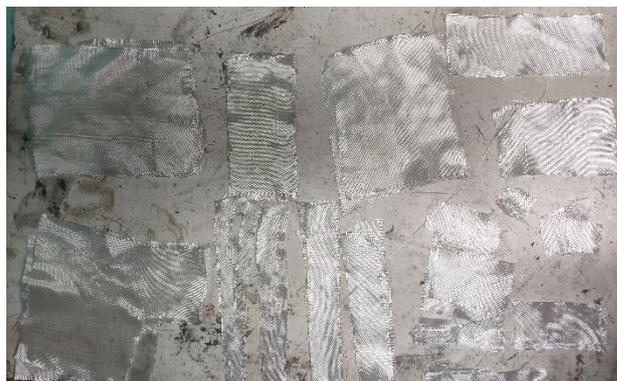
Figura 61 - Fibra de vidro necessária para a construção da caixa.
