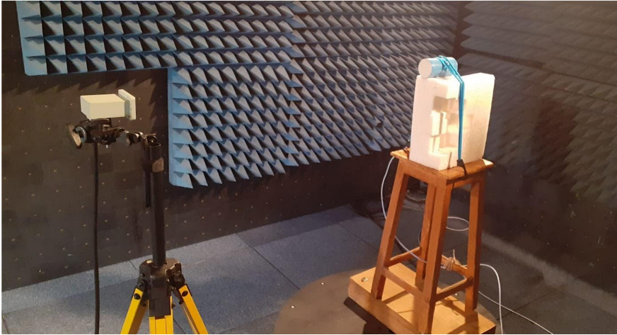
Figura 4.14: Fotografia della camera anecoica con le due antenne. A sinistra l'antenna a tromba con caratteristiche elettromagnetiche note e certificate, a destra l'antenna in prova.
