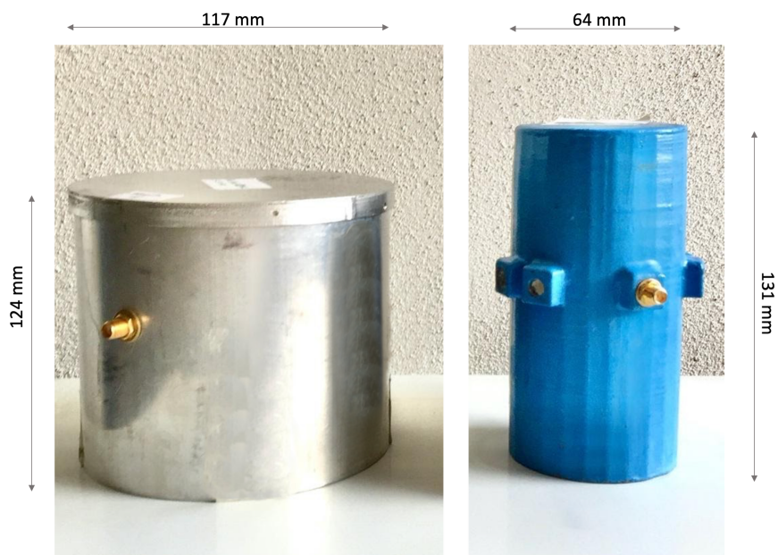
Figura 4.13: Fotografie delle antenne fabbricate con indicate le dimensioni principali; A sinistra l'antenna costruita in officina meccanica con la cavità riempita di aria, a destra l'antenna stampata in tre dimensioni.
