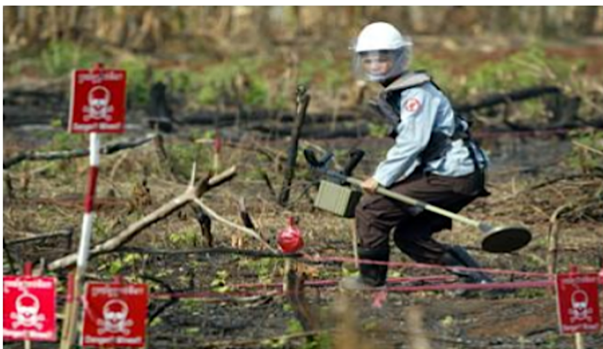
Figura 2.1: Personale qualificato in attività di sminamento per scopi umanitari con metodi approvati dalle Nazioni Unite (in questo caso un sensore portatile di tipo elettromagnetico). Immagine per cortesia di ICRC, Halo Trust, PM/HDP
