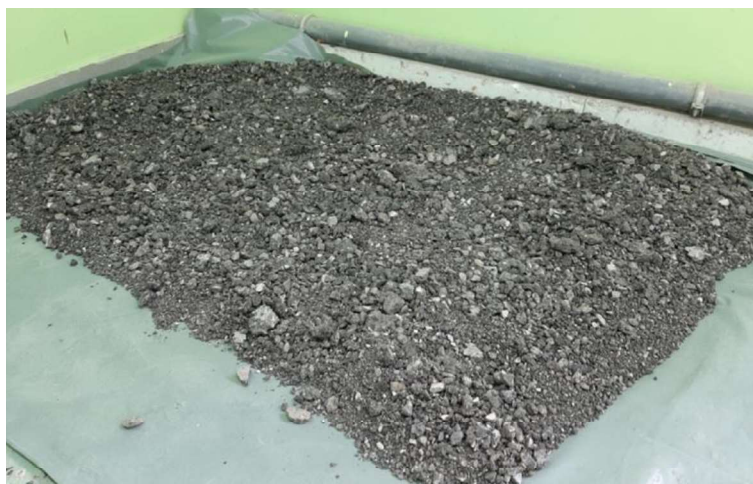
Slika 2 – Sušenje i homogenizacija RAP-a – lokacija Požega
