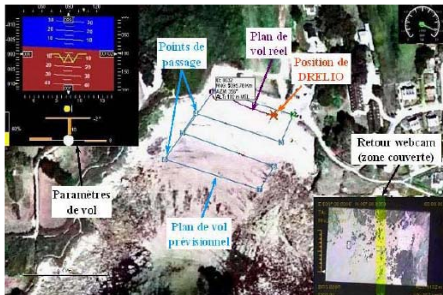
Figure 2. Ecran de contrôle de l'auto-pilote.
