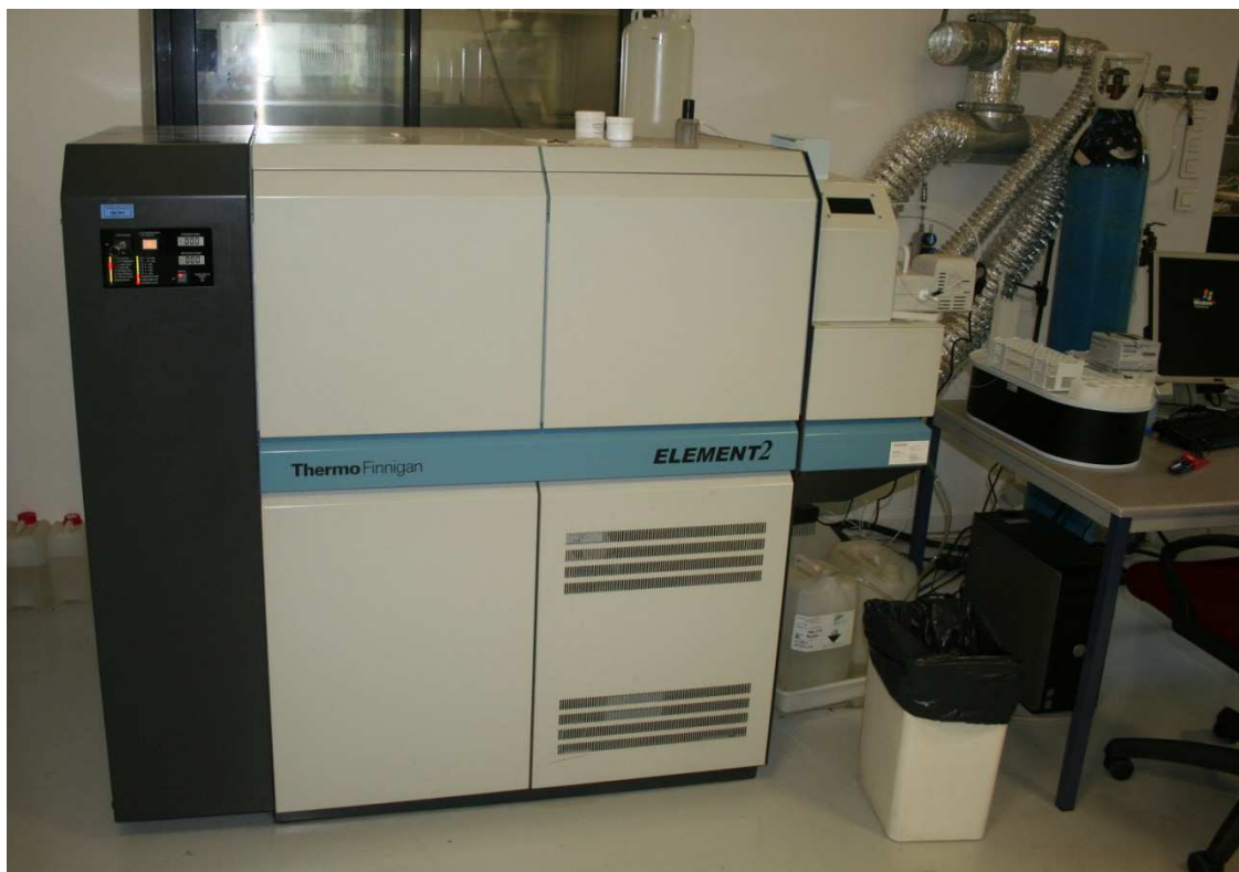
Figure II-19 : Photographie de l'Element 2 de ThermoFinnigan avec lequel les rapports Lu/Hf et les isotopes du Pb des zircons en solution ont été mesurés. Cette même machine a été utilisée pour les analyses ponctuelles à la Washington State University mais cette fois couplée au laser visible dans la Figure II-15a. Crédit photographique : Martin GUITREAU.
