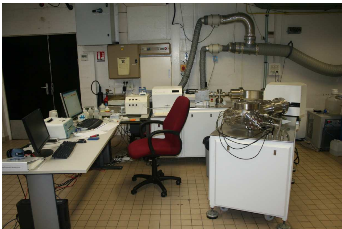
Figure II-16 : Nu Plasma 500 HR avec lequel ont été analysées les compositions isotopiques d'Hf des TTG et des zircons ainsi que les compositions isotopiques du Lu des TTG. Crédit photographique : Martin GUITREAU.
