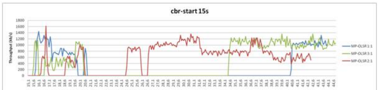
Figure 5.3 — Scénario1. Débit instantané calculé sur une fenêtre de 0.1 s en fonction du temps de la simulation, le flux CBR commence à 10s et s'arrête à 45s.
