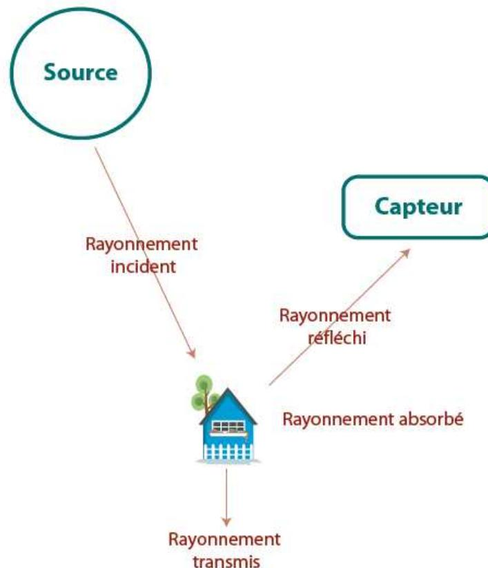
Figure 1 : Absorption, réflexion, transmission (d'après Bonn et Rochon, 1992)
