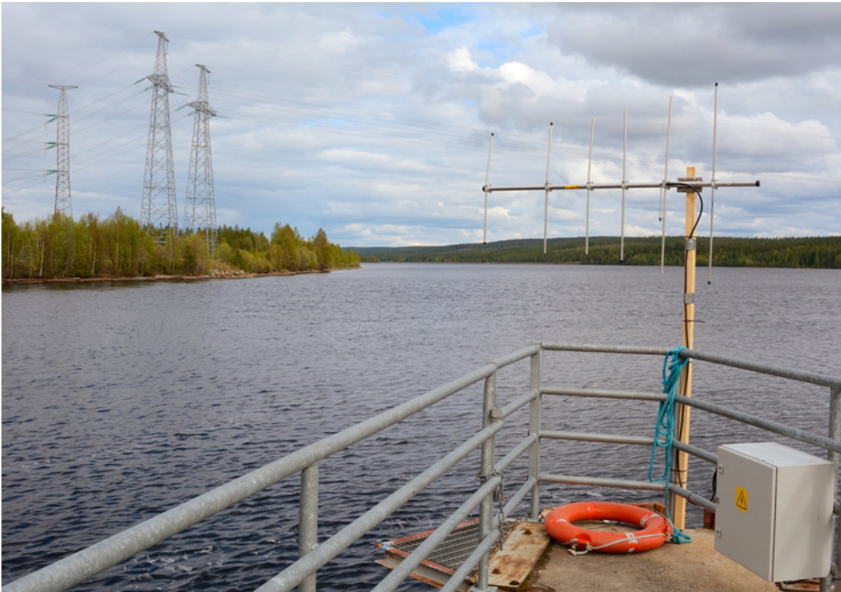
Kuva 4. Radiolähettimien automaattinen seurantapisteen K3.1 välittömästi Valajaskosken voimalaitoksen yläpuolella. Seurantapisteen koostuu 6-elementtisestä Yagi-antennista ja siihen koaksiaalikaapelilla yhteydessä olevasta Lotek SRX_DL3 radiovastaanotimesta (sijoitettuna harmaaseen laatikkoon). Kuva: Panu Orell.
