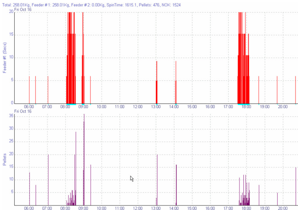
Kuva 3. Esimerkki Akvasmartin rehun annostelukerroista (ylempi, sekuntia) ja sensorin mittaamista syömättä jääneistä pelleteistä (alempi, kappaletta) yhden päivän aikana (klo 5.00-21.00). Tässä esimerkissä kalat ovat syöneet hyvin noin puolen tunnin ajan aamulla (klo 8.00-8.30) ja illalla (klo 17.30-18.15). Päivällä testatut rehulisäykset eivät ole herättäneet kalojen ruokahalua.
