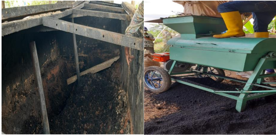
Gambar 2. Proses pembuatan biochar dari limbah tongkol jagung
