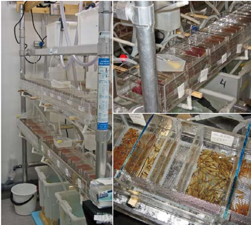
Kuva 1. Kuva vasemmalla: Yleiskuva haudontalaitteistosta. Kummassakin rivissä on kaksi haudontakaukaloa. Kuva oikealla ylhäällä: Yksi haudontakaukalo koostuu viidestä asetista. Kuva oikealla alhaalla: Asetissa on yhtä mätierää varten kolme lokeroa, yksi lasketuille (140 kpl) mätimunille, yksi kuoriutuneille poikasille ja kolmas mikroskopointia ja muita tutkimuksia varten varatuille mätimunille ja poikasille. Vesi on ohjattu virtaamaan pohja- ja etuverkon kautta lokeroiden läpi.
