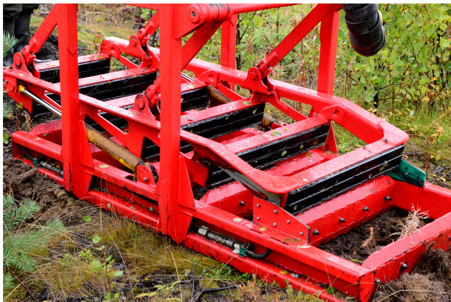
Fig. 1. Uprooting device P25_v1 (Photo: Ville Kankaanhuhta).
