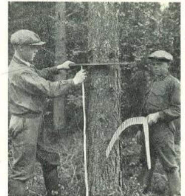
Rinnankorkeuslapiaman mittaaminen käyräasteikkosella kulmakaulaimella. (Y. I-o.)
