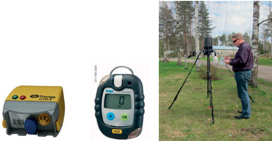
Kuva 6. Käytetyt mittausanturit; vasemmalla TinyTag lämpötila ja suhteellinen kosteus -anturi, keskellä Dräger Pac 7000 NH 3 -anturi ja oikealla A-Lab-sääasema tuulen nopeuden ja suunnan, lämpötilan, sademäärän ja suhteellisen kosteuden mittaukseen.
