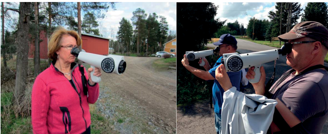
Kuva 4. Hankkeessa käytetty kannettava olfaktometri. Hajua laimennetaan aktiivihiilen läpi johdetulla ilmalla aina vain vähemmän, kunnes haju havaitaan. Laitteella saatava tulos on siis laimennussuhde. (Kuvat: Hannu Haapala)
