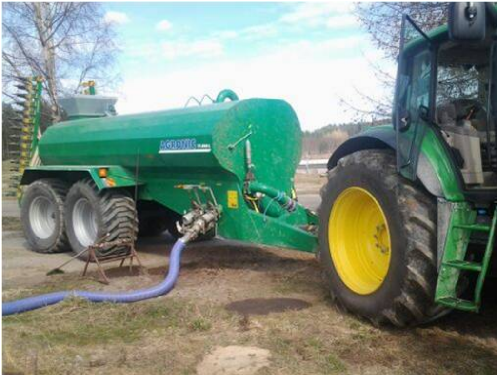
Kuva 3. Lietevaunu kiekkomultaimella, vaunun täyttö käynnissä.
