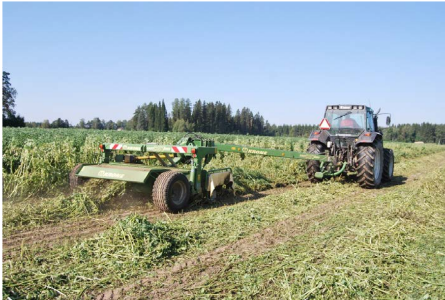
Kuva1. Härkäpavun niitto hinattavalla niittomurskaimella, jonka työleveys oli 3,2 m. Koneen murskainosa oli varstatyyppinen V-mallisin sormin varustettu.
