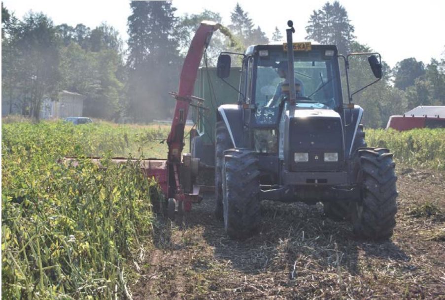
Kuva 2. Härkäpavun toisena korjuukoneena oli kasvustoa suoraan niittävä kaksoisilppuri, jonka työleveys oli 1,7 m.
