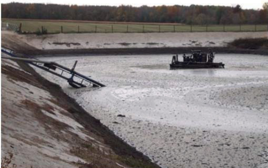
Kuva 9. Suurten lietealtaiden tehokkaaseen sekoittamiseen kehitetty moottorivoimalla liikkuva kelluva sekoitin, kuva Yhdysvalloista.
