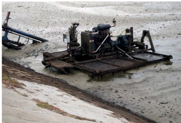
Kuva 9. Suurten lietealtaiden tehokkaaseen sekoittamiseen kehitetty moottorivoimalla liikkuva kelluva sekoitin, kuva Yhdysvalloista.
