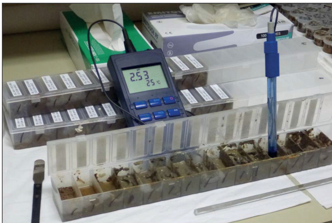
Kuva 3. Profiilipistenäytteiden inkubointi laboratoriossa. Kuva: Hannu Hirvasniemi
