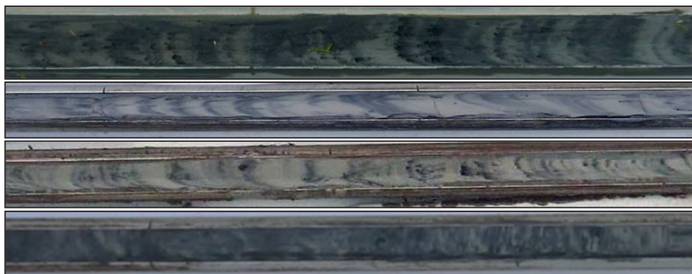
Kuva 8. Sulfidiraitoja kairanäytteissä. Kuva: Pentti Kouri
