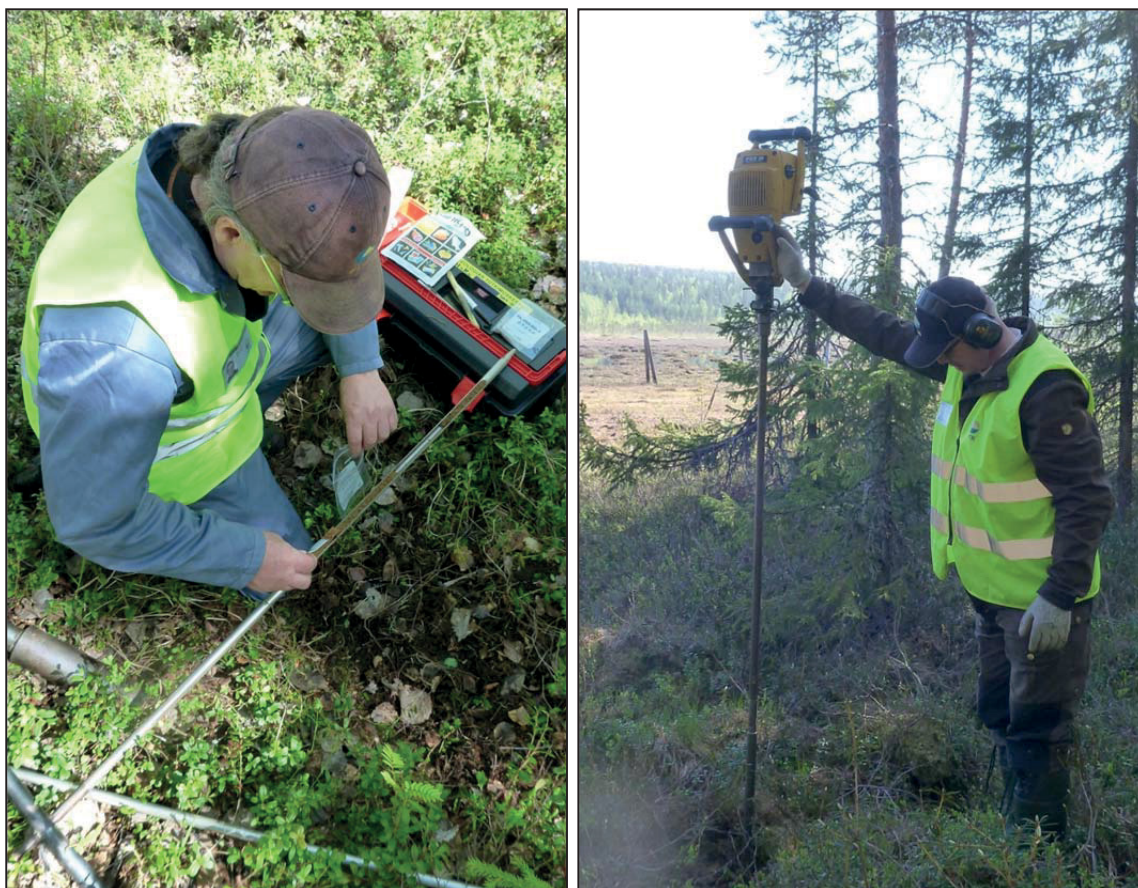
Kuva 2. Vasemmalla pH-näytteenottoa maaperäpiikin näytteenottourasta. Oikealla meneillään profiilinäytteen kairaus. Kuvat: Pauliina Liwata-Kenttälä
