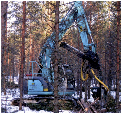
Kuva 8. Suometsien harvennuksiin on kehitetty omia koneratkaisuja. Kuvassa kaivukoneeseen liitetty hakkuulaite. (Kuva: Jani Heikkilä).
