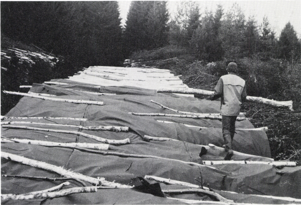
Kuva 10. Painot heitetään kattamisen viime vaiheessa peitteiden päälle. Etualalla bitumikreppiä ja taustalla sahatavarakäärettä. Figure 10. Weights are placed on the stacks after covering. In the foreground bitumen crepe paper covers, in the background sawn goods covering.
