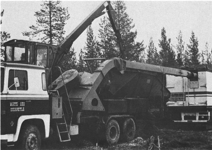
Kuva 1. TT 1500 L varastohakkuri hakettamassa suoraan kuorma-auton perävaunuun (Kuva Työväline Oy). Fig. 1. The TT 1500 L landing chipper chipping directly into the truck trailer (Photo Työväline Oy).
