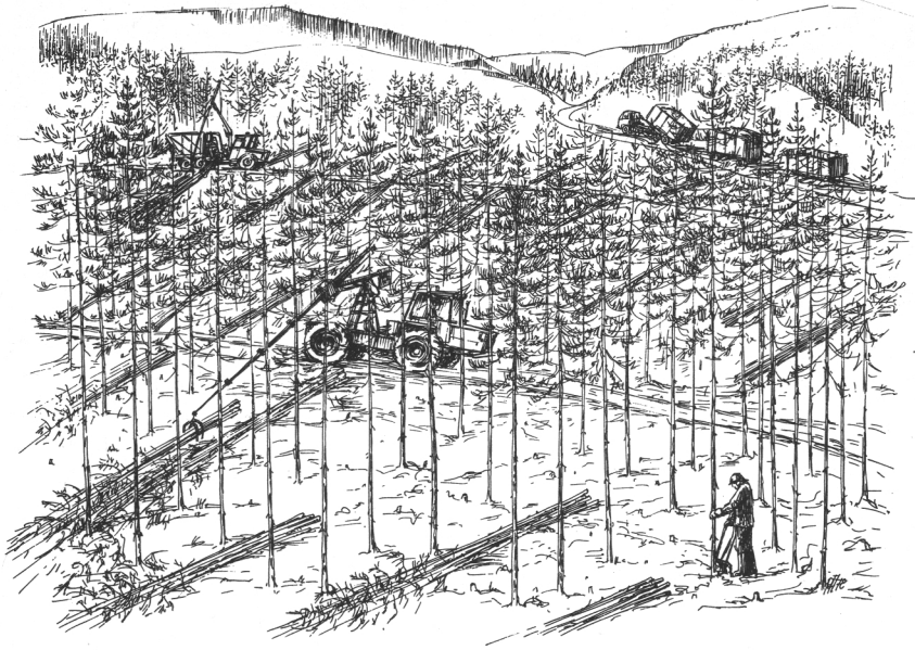
Kuva 9. Korjuuketju 2. Kaato ja kasaus siirtelykaatomenetelmällä, lisäksi erillinen kasaus ajouran varteen Normetin kasausslaitteella. Haketus ajouralta. Ajouraväli 30 metriä. Fig. 9. Harvesting schedule 2. Manual felling and bunching by chain saw, in addition mechanised bunching alongside the strip road by the Normet buncher. Chipping on the strip road. Strip road spacing 30 m.
