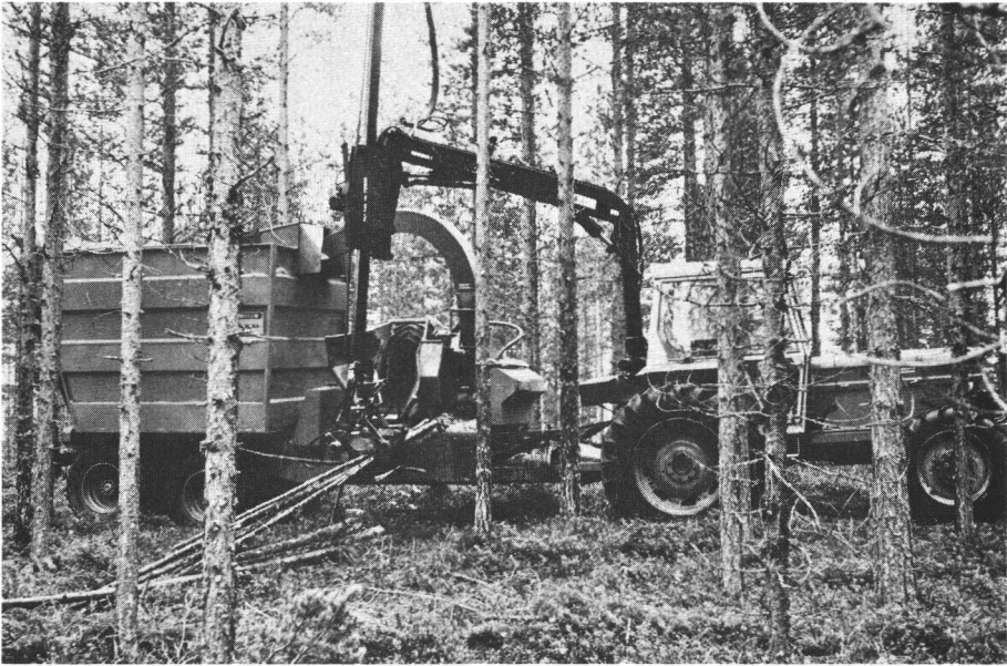
Kuva 4. Palstahakkurin prototyyppi PH-3. Fig. 4. The PH-3 terrain chipper prototype.
