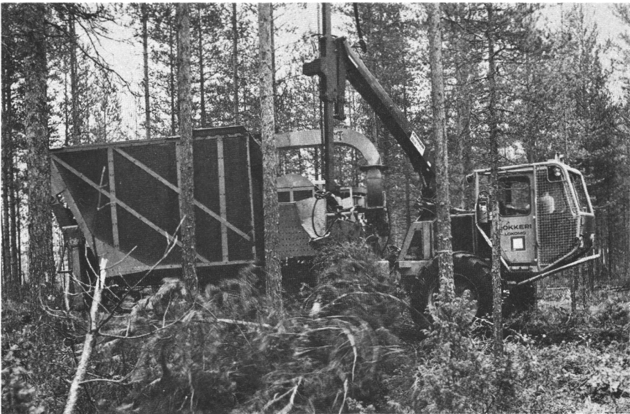
Kuva 5. TT 1000 F palstahakkuri hakettamassa ensiharvennusmäntyä ajouralla. Peruskoneena Lokomo 928 kuormatraktori. Fig. 5. The TT 1000 F terrain chipper prototype chipping small-sized pine on the strip road. The basic machine is a Lokomo 928 forwader.
